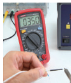
03. UT33C+可用K型热电偶测试
